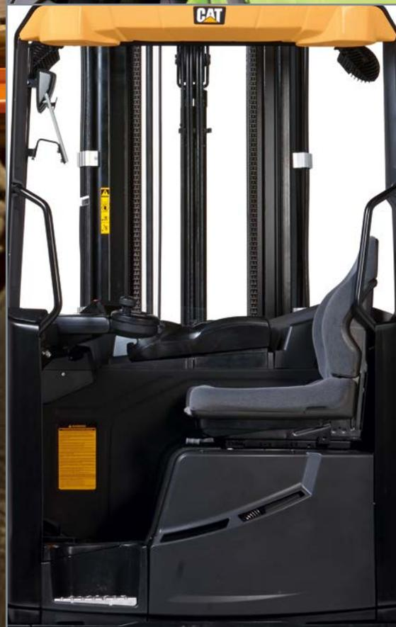
Visibilità dell'operatore eccezionalmente sgombra (immagini a sinistra e in alto), con cavi e tubazioni attentamente posizionati e cilindri idraulici incorporati nel profilo del montante (estrema sinistra).
